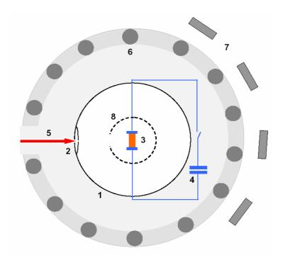
Рис. 9: Приблизительная схема эксперимента для измерения выхода нейтронов из плазменной бериллиевой мишени.
