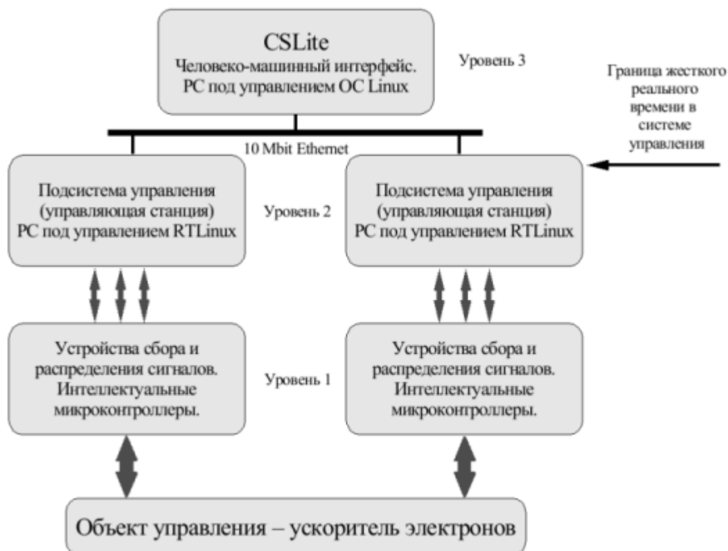
Рис.1. Схема системы управления ускорителей НИИЯФ МГУ.
