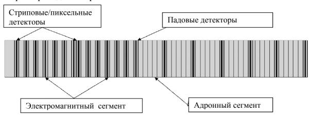
Рис. 1. Структура переднего калориметра эксперимента PHENIX.
