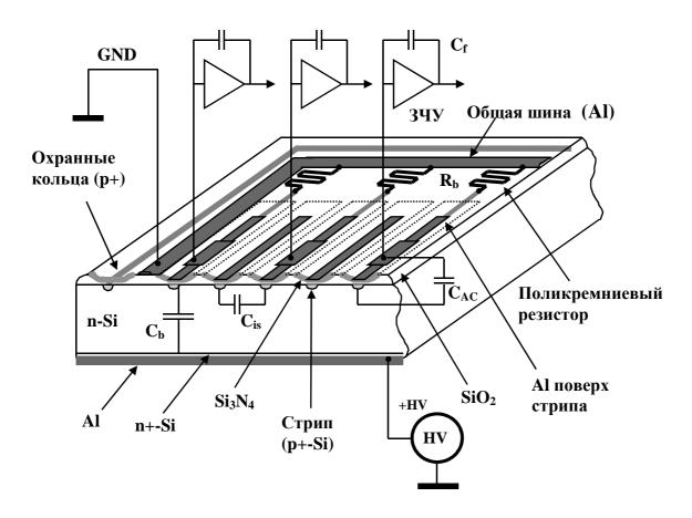
Рис. 5. Структурная схема микрострипового детектора.
