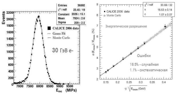
Рис.3. Восстановленная энергия и разрешение калориметра.
