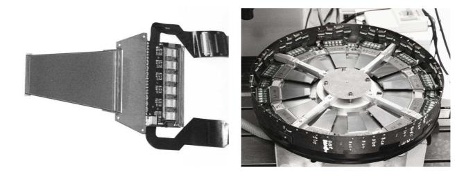
Рис.6. Модуль передней части трековой системы.
