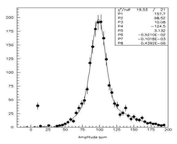
Puc.2. Восстановленная энергия в прототипе калориметра PHENIX.
