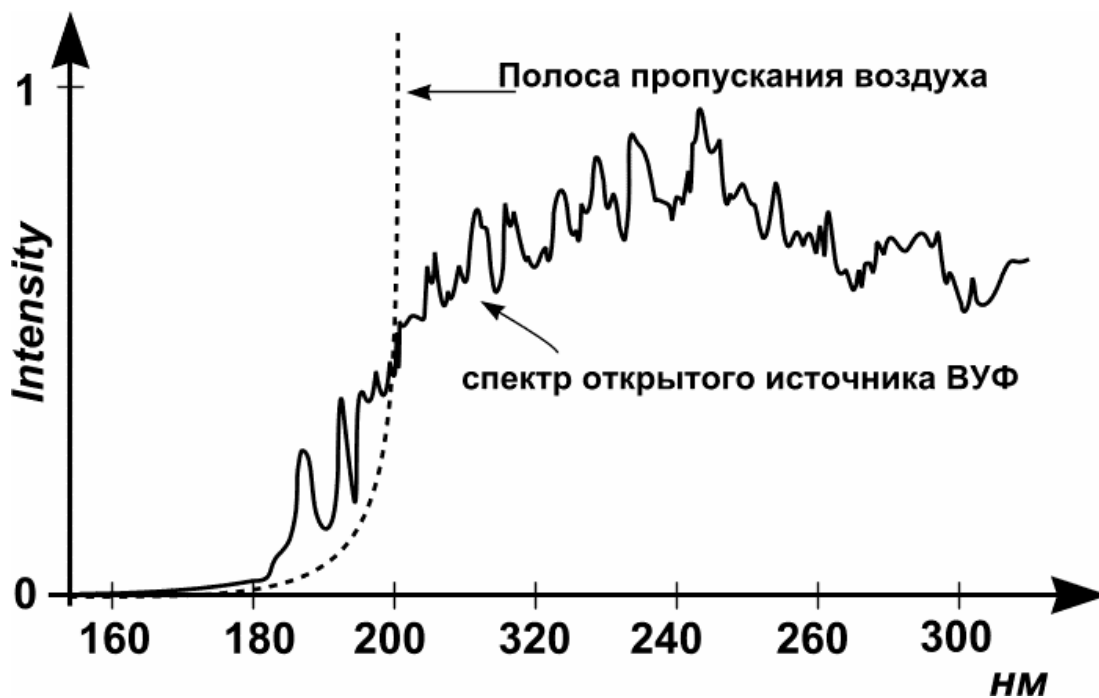
Рис.3. Характерный спектр испускания микрошнуров плазмы при работе источника УФ в атмосфере окружающего воздуха.
