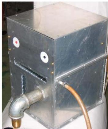
Рис. 5. Внешний вид установки для очистки воды озono-гидроксильной смесью производительностью 1 м<sup>3</sup>/час.
