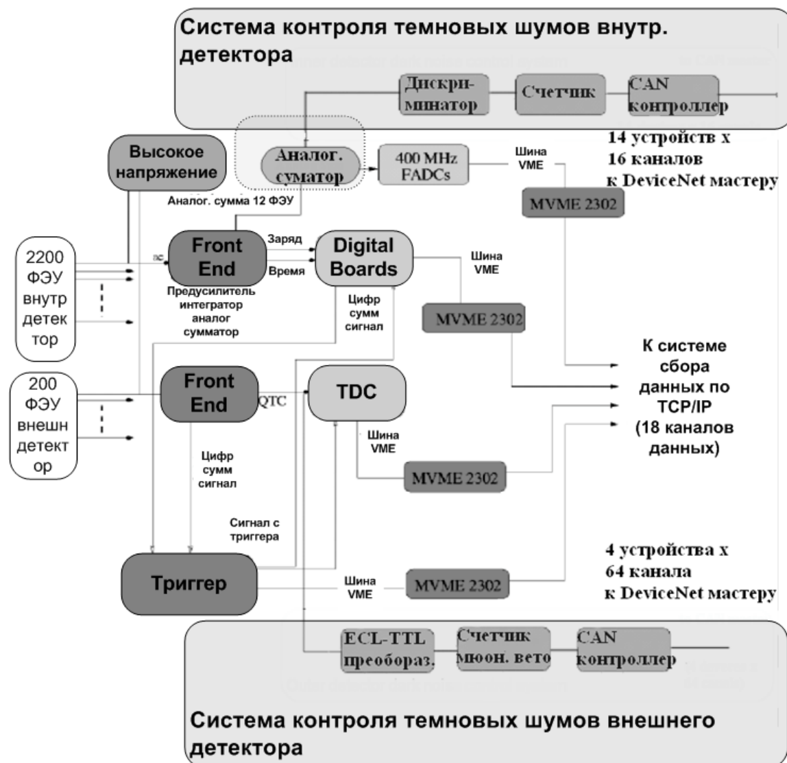
Рис. 2. Блок-схема аппаратной части системы контроля и сбора данных Borghino.
