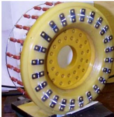
Рис.7. Опытные образцы точечного (А.) и кольцевого (Б.) источников УФ, изготовленные в НТЦ «МИТ», ФГУП НИИЭФА им. Д.В. Ефремова (С.-Петербург) при выполнении совместных НИОКР.
