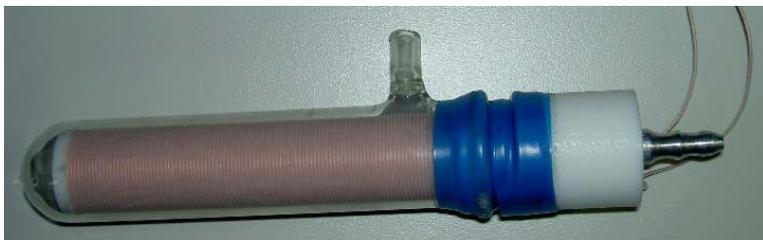
Рис.21. Опытный образец источника УФ или озона на основе барьерного разряда с новой структурой электродов.
