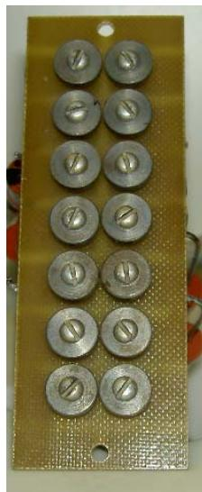
Рис.4. Опытные образцы источников УФ на основе сильноточного RCL - разряда короткой длительности, представляющего собой схему Аркадьева-Маркса. Источником питания служит стандартный высоковольтный выпрямитель, частота следования импульсов УФ излучения определяются величиной тока и может регулироваться в пределах  $F = 1 - 10^5$  Гц при энерговкладе в отдельный микрошнур плазмы  $W = 1 - 10^{-4}$  Дж и длительности УФ излучения порядка 0,1 – 1 мкс.
