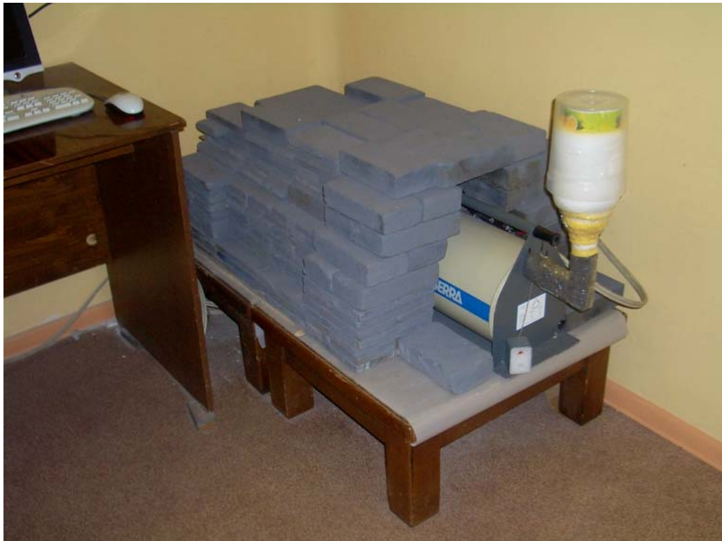
Рис. 3. HPGe детектор \gamma -квантов в свинцовой защите (Canberra, GC3019).
