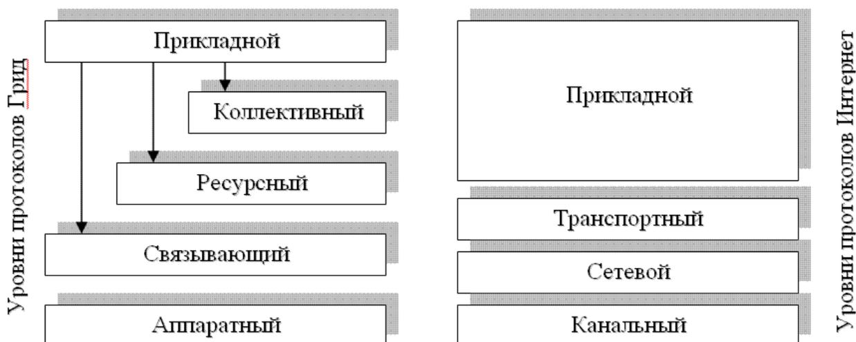
Рис.2 Стеки протоколов грид-системы и сетевой модели.
