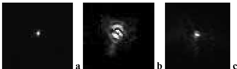
Рис. 4. Распределение интенсивности в дальнем поле. а – без накачки; б – с накачкой без коррекции; с – с накачкой после коррекции
